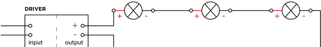
In einer Reihenschaltung bleibt der Strom über den Stromkreis gleich.
